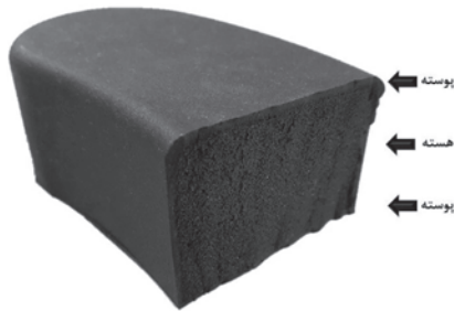
شکل ۱. ساختار فوم اینتگرال (فوم خود پوسته) پایه گاز یا پایه حلال.
